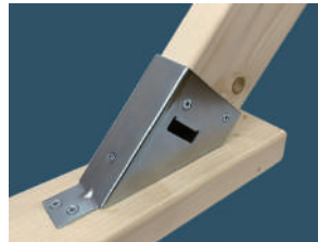
コーナー金具 C-3 筋交いや、庇(ひさし)の受け金具などに使用。木材を斜めカットする事なく45°の柱を付ける事ができます。
