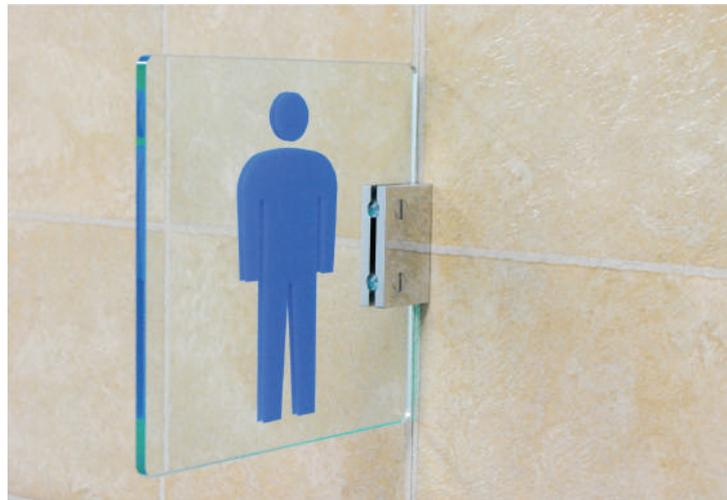
今まで面倒だったピクトサインの取り付けを簡単に行なう事ができます。サインパネルには $\phi$ 7の穴を2つあけるだけの簡単加工です。壁への取り付けは別体パーツを使用すること無く、金具に直接ビスを打ち込むタイプで、施工の際の手間の削減ができ、位置決めも簡単です。金具の単純構造化をはかり、重厚で高級感のある仕上がりでありながらコストを抑えた施工が実現できます。全てのパーツが削り出しで製造されております。仕上げは鏡面クロームメッキです。
