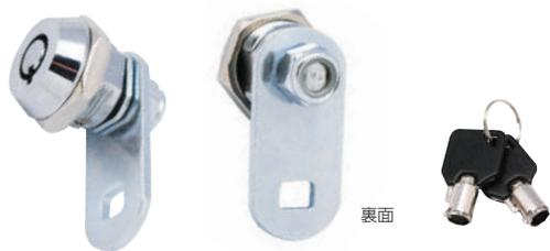
サークル型の鍵穴により鍵違い番号は 1,000 種以上です。カム板の固定には緩み防止効果にすぐれたナイロンナットを使用しています。解錠時には鍵が抜けない構造になっています。扉などに使用するときにはノブとして使用ができます。板金用ロックとしても幅広くご利用いただけます。
