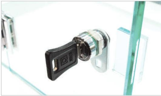
独特なスリット形状の鍵により鍵違い数が 10,000 以上とセキュリティ性に優れたシリンダー錠です。解錠時には鍵が抜けない構造になっています。扉などに使用する際にノブとして使用ができます。カム板の固定がナットではなくEリング留めのため緩みが発生しにくい構造です。カム板の開閉角度を 90°毎に変えることができます。
