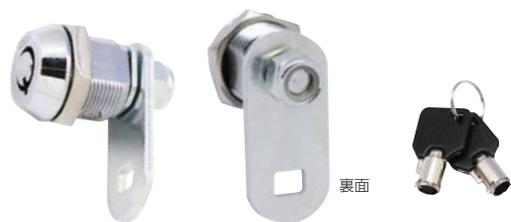
サークル型の鍵穴により鍵違い番号は 1,000 種以上です。カム板の固定には緩み防止効果にすぐれたナイロンナットを使用しています。解錠時には鍵が抜けない構造になっています。扉などに使用するときにはノブとして使用ができます。板金用ロックとしても幅広くご利用いただけます。
