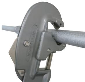
軽量で薄鋼板 (1.2mm 厚) のパイプを使用しているので、パイプカッターでカットすることができます。現場での微調整にも電動工具無しで対応可能です。
