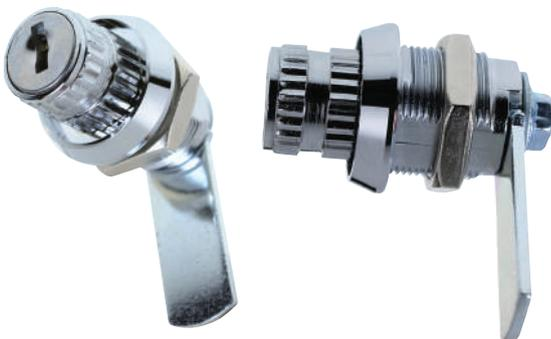
解錠時はノブを持って開閉できますので、ボックスを開ける際にいちいち鍵を挿し込む必要がありません。ノブ部分が別体式になってるので、使用する場所、イメージによって外観を変更することが出来ます。ノブを嵌合する歯車は 15°の角度で山が立っており、これによりノブも 15°の角度で調整が可能です。狭い部分や、どうしても角度をつけなければならない箇所に便利な作りとなっています。ノブ取り付け時に見える本体部分は美しいクロームメッキ加工になっています。
